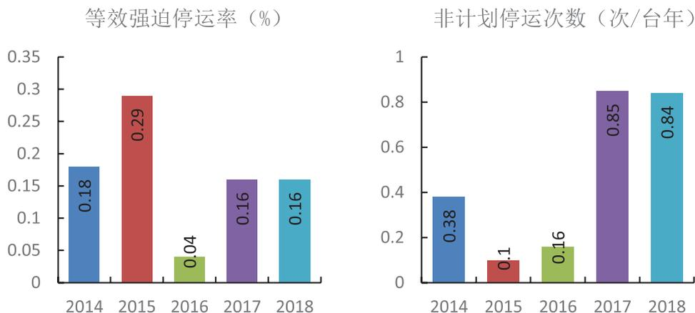
图 2-34 新投产 40 兆瓦及以上水电机组投产后第一年运行可靠性指标
